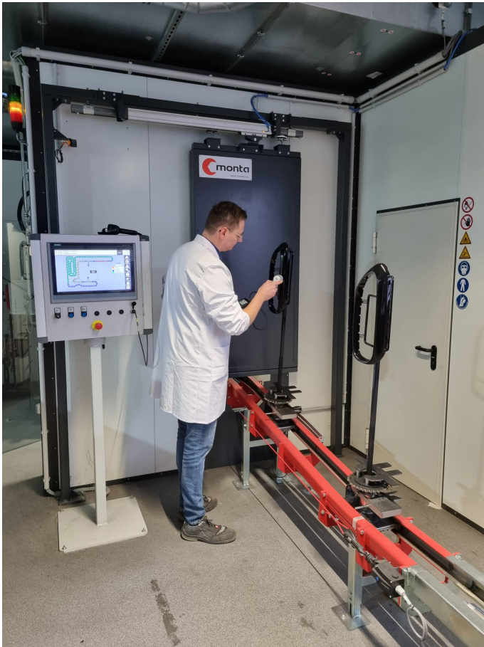
Mit dem PaintChecker wird die Gleichmäßigkeit des Auftrags im noch nassen Zustand geprüft
