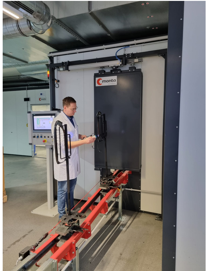
Prüfung von Nasslack auf Chrom vor dem Einbrennen
