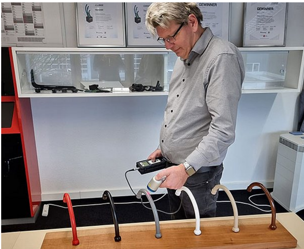
Die Nasslack-Beschichtung der hochwertigen Chrom-Armatur wird von Fertigungsleiter Holger Salzmann regelmäßig mit dem PaintChecker Mobile von OptiSense kontaktlos überprüft (Bild: OptiSense)
