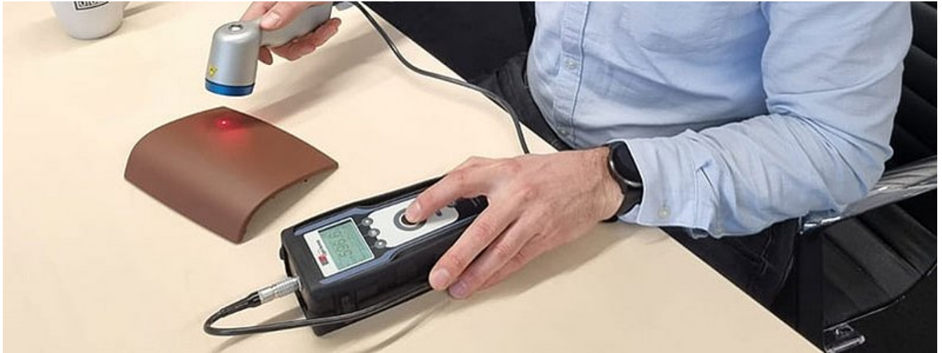
Schichtdicke von Nasslack-Lackierung auf Chrom vor dem Einbrennen messen (Bild: OptiSense)
