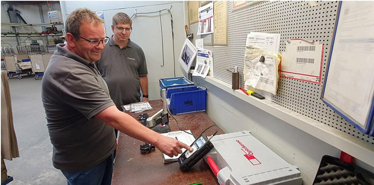
Schichtdickenprüfung mit dem PaintChecker Mobile von Optisense (Martin Kolenda, Marco Jobst, von li) (Bild: Optisense)
