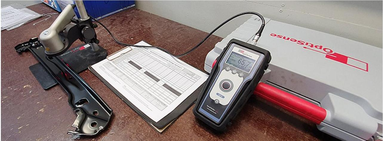
Fehlbeschichtungen bei Autofenster-Führungsschienen werden durch eine frühzeitige Schichtdickenmessung vor dem Einbrennen des Pulverlacks vermieden (Bild: Optisense)
