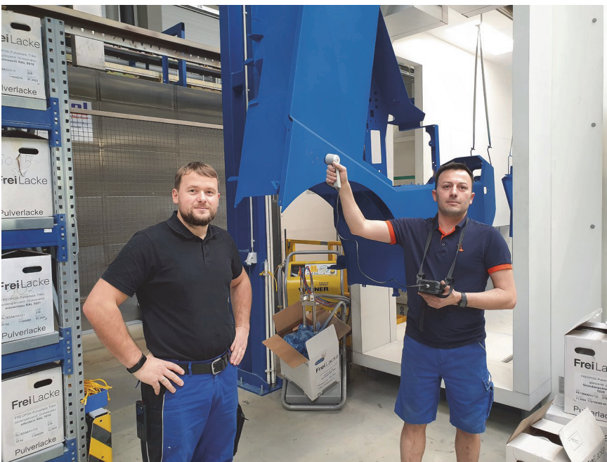
Benedikt Seidel, Meister und Abteilungsleiter Lackiertechnik (links) im Gespräch mit Schichtführer Turo Zoltan (beide von der Brückner Gruppe), der mit dem mobilen Messgerät die Werkstücke prüft – hier einen blauen Kraftstofftank für einen Futtermischwagen.
