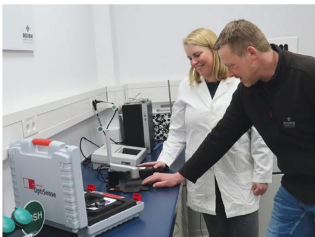
Silke Elles und Florian Paland nutzen den „PaintChecker Mobile“, um die Anti-Knarzeigenschaften von Automobillacken zu optimieren.
