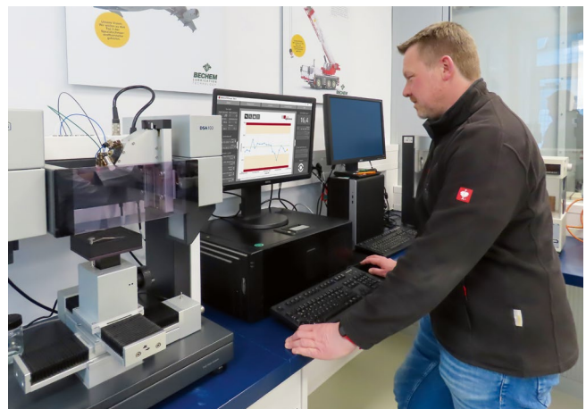
Die Lacklösungen für vibrationsbedingte Störgeräusche werden von Silke Elles und Florian Paland mit dem PaintChecker Mobile analysiert und dokumentiert.
