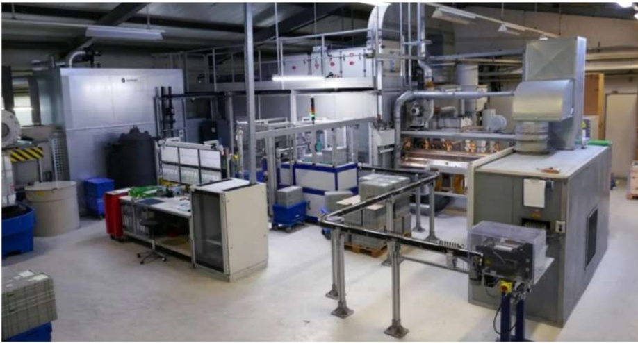
Oversiktbild över lackeringsanläggningen för täcklock.
