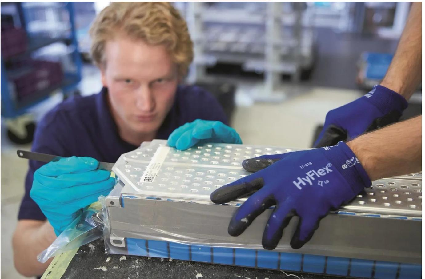
Das Aluminiumgehäuse der Batteriezelle ist mit einer blauen UV-Beschichtung versehen, die sowohl die Oberfläche schützt als auch die notwendige Isolationsfunktion übernimmt.
