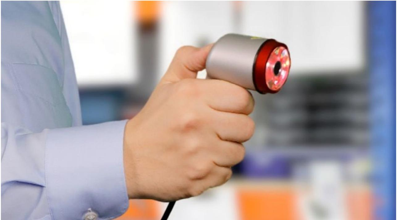
Wie alle Systeme von Optisense kann das Handgerät Lacke oder Pulver bereits vor dem Aushärten prüfen; wenn also der Auftrag noch nass beziehungsweise weich ist. Durch eine einfache Messung direkt nach dem Auftragen kann das sehr kostenintensive Nacharbeiten oder auch teure Überbeschichtungen komplett vermieden werden. So bietet das berührungslose Verfahren sofort die optimale Qualitätskontrolle und eine deutlich höhere Prozesssicherheit.
