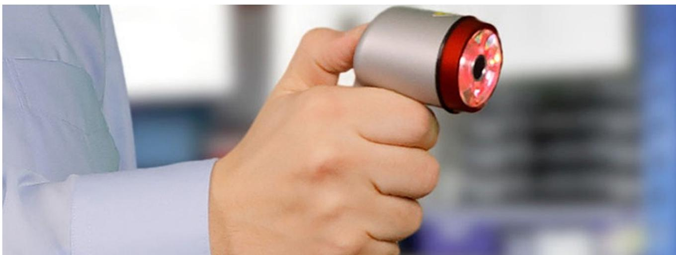
PaintChecker Mobile: Mobile Schichtdickenmessung von OptiSense (Bild: OptiSense)
