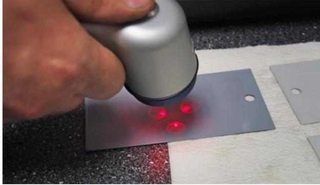
Bei der Messung richtet Carsten Vogelsang den Sensor auf das zu messende Objekt, so dass sich die drei Position-LEDs in einem Punkt vereinen. Dies erfordert etwas Übung.
