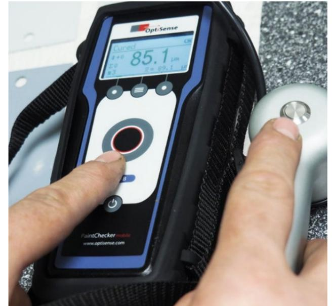
Bei dem weiterentwickelten Gerät kann die Messung nun am Kopf der LED-Pistole oder direkt am Gerät ausgelöst werden kann.
