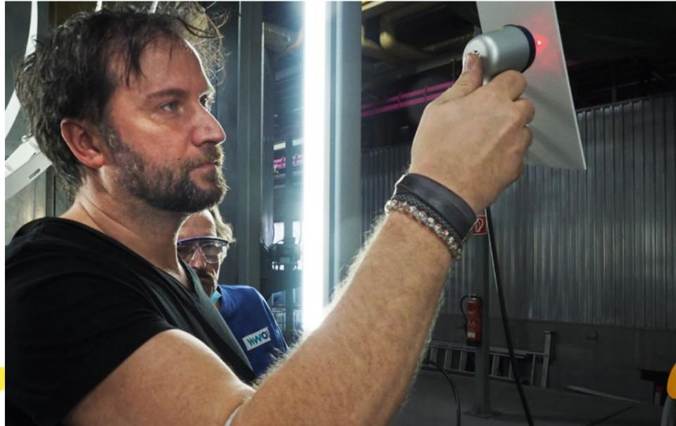
Die Messungen kann Carsten Vogelsang schnell durchführen. Diese erfolgen bei WWO unmittelbar nach der Pulverapplikation vor dem Einbrennprozess.
