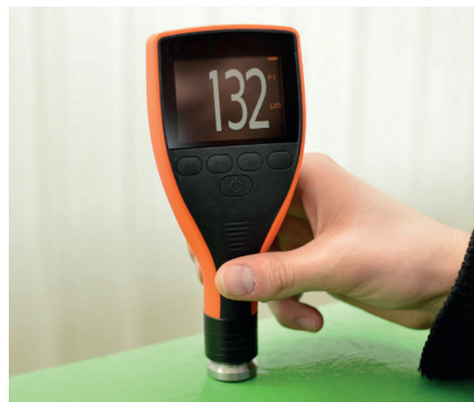
Abb. 2: Berührungsbehaftete Messverfahren wie die Wirbelstromtechnik (links) setzen direkt auf dem Werkstoff auf, während das kontaktlose und zerstörungsfreie Photothermieverfahren (rechts) aus der Distanz arbeitet
