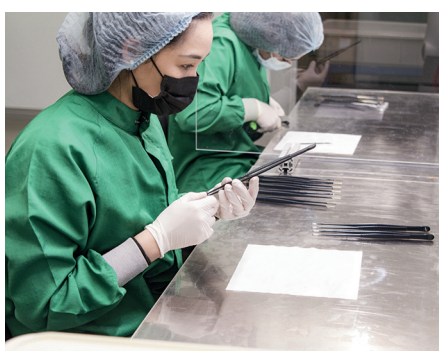
Abb. 1: Bei chirurgischen Instrumenten werden höchste Ansprüche an das Material, die Beschichtung, die Konstruktion und die Fertigung gestellt. Neben strengen Hygienestandards muss die Oberfläche auch haptischen, ergonomischen und technischen Anforderungen wie Durchschlagsfestigkeit genügen. Deshalb ist eine präzise Schichtdicke überaus wichtig.
