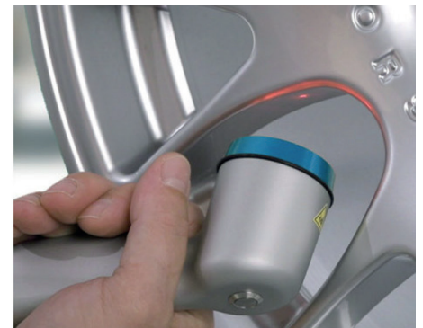
Abb. 2: Berührungsbehaftete Messverfahren wie die Wirbelstromtechnik (links) setzen direkt auf dem Werkstoff auf, während das kontaktlose und zerstörungsfreie Photothermieverfahren (rechts) aus der Distanz arbeitet
