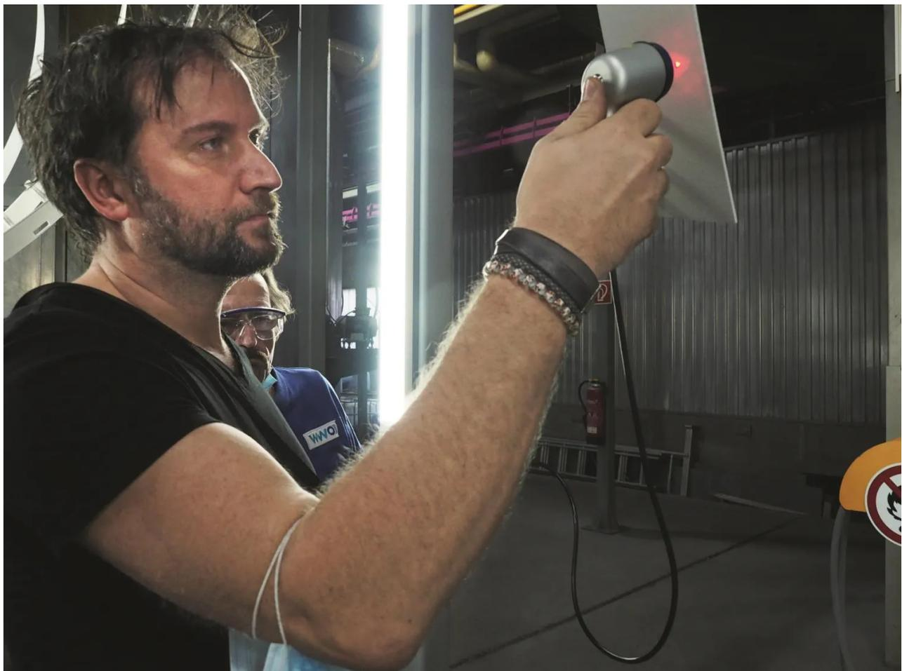
Die Messungen kann Carsten Vogelsang schnell durchführen. Diese erfolgen bei WWO unmittelbar nach der Pulverapplikation vor dem Einbrennprozess.
