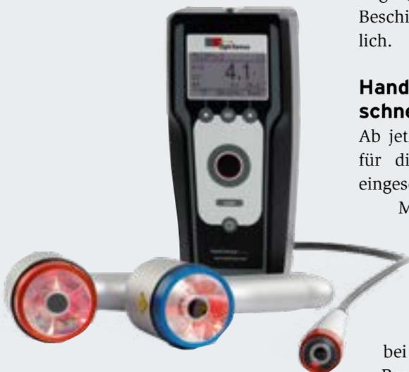
Das fotothermische Messsystem Paintchecker Mobile arbeitet ohne jeglichen Kontakt zum Objekt. So kann die Beschichtungsqualität bereits vor dem Einbrennprozess kontrolliert und damit eine prozesssichere Bearbeitung garantiert werden.
