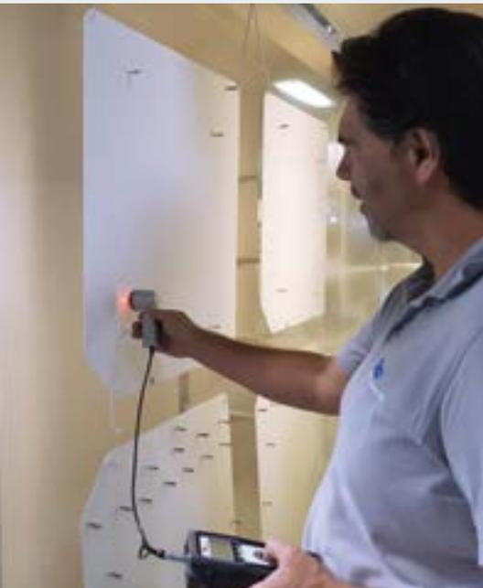
Begleitend zu den By-the-Line-Messungen werden auch stichprobenartige Untersuchungen per Schichtdickenmessung am Produkt durchgeführt
