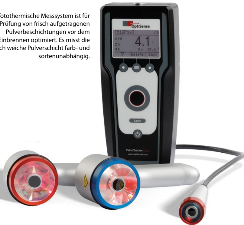
Vor dem Einbrennen wird die Schichtdicke kontrolliert. Dabei wird auch die Schrumpfung während des Aufschmelzens berücksichtigt.
