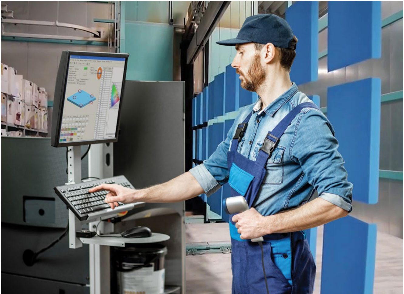
Vor dem Einbrennen wird die Schichtdicke kontrolliert. Dabei wird auch die Schrumpfung während des Aufschmelzens berücksichtigt.
