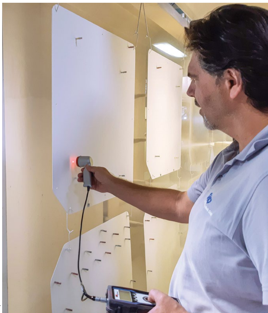
Horst Schuller, Geschäftsführer von GSO Oberflächentechnik, prüft die Schichtdicke mit dem mobilen Messsystem; dieses arbeitet ohne jeglichen Kontakt zum Objekt.
