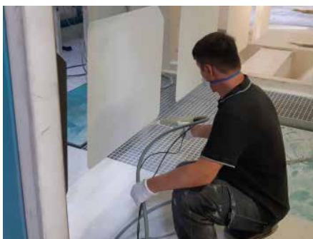
Bei schnellen Farbwechseln von Einzel- und Musterteilen wird in der Kleinteilekabine beschichtet. Hier ist noch Handarbeit gefragt. Der Mitarbeiter beschichtet die Teile vor. Das ist vor allem bei Teilen mit Ecken, Kanten oder Winkeln eine anspruchsvolle Aufgabe.
