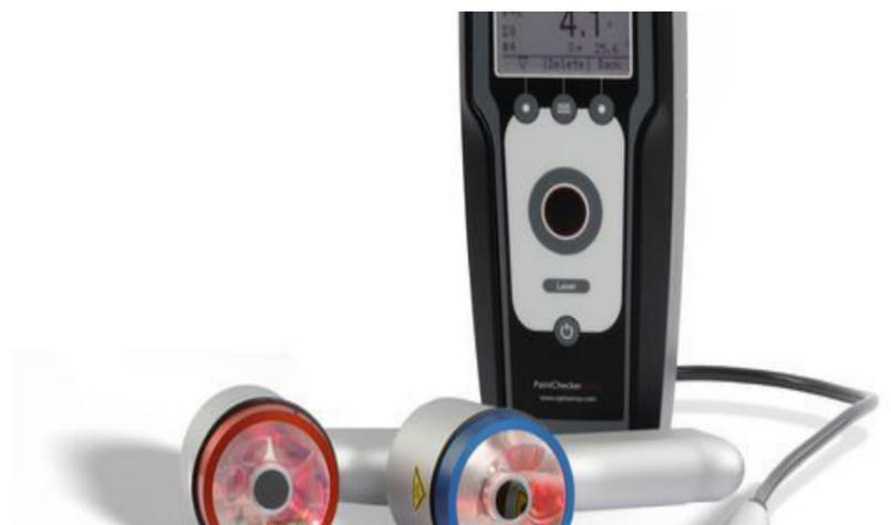
Jetzt übernimmt der PaintChecker mobile von OptiSense die Prozessüberwachung, denn eine berührungslose Messung ist Grundvoraussetzung, um die Beschichtung nicht zu zerstören. Das Beschichtungsergebnis wird vor dem Einbrennen mit dem leichten, flexiblen Handgerät geprüft und die Anlage kann bei Bedarf sofort nachjustiert und die Beschichtung optimiert werden.
