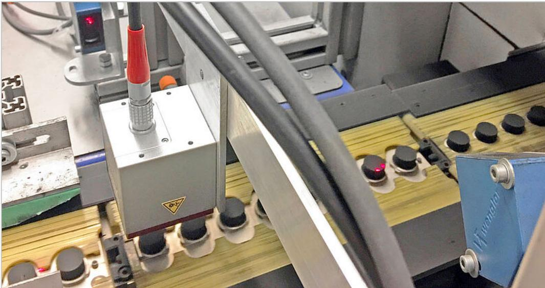
*Hundert Prozent Kontrolle: Inline Schichtdickenmessung mit einem thermographischen Sensor für pulverbeschichtete PDC-Sensoren. Bild Optisense*
