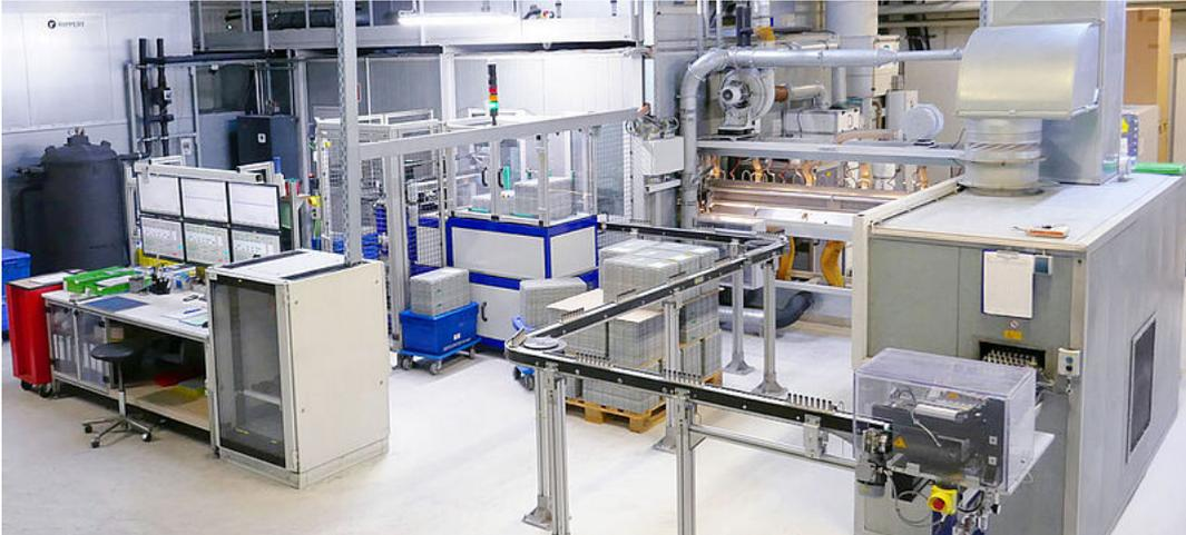
*Vorbehandlung, Pulverbeschichtung, Inline-Schichtdickenmessung, Einbrennen und per Roboter palletieren – ein hoher Automatisierungsgrad war der Schlüssel für den ILB Biedermeier, um anspruchsvolle Aufträge aus der Automobilindustrie zu gewinnen.*
