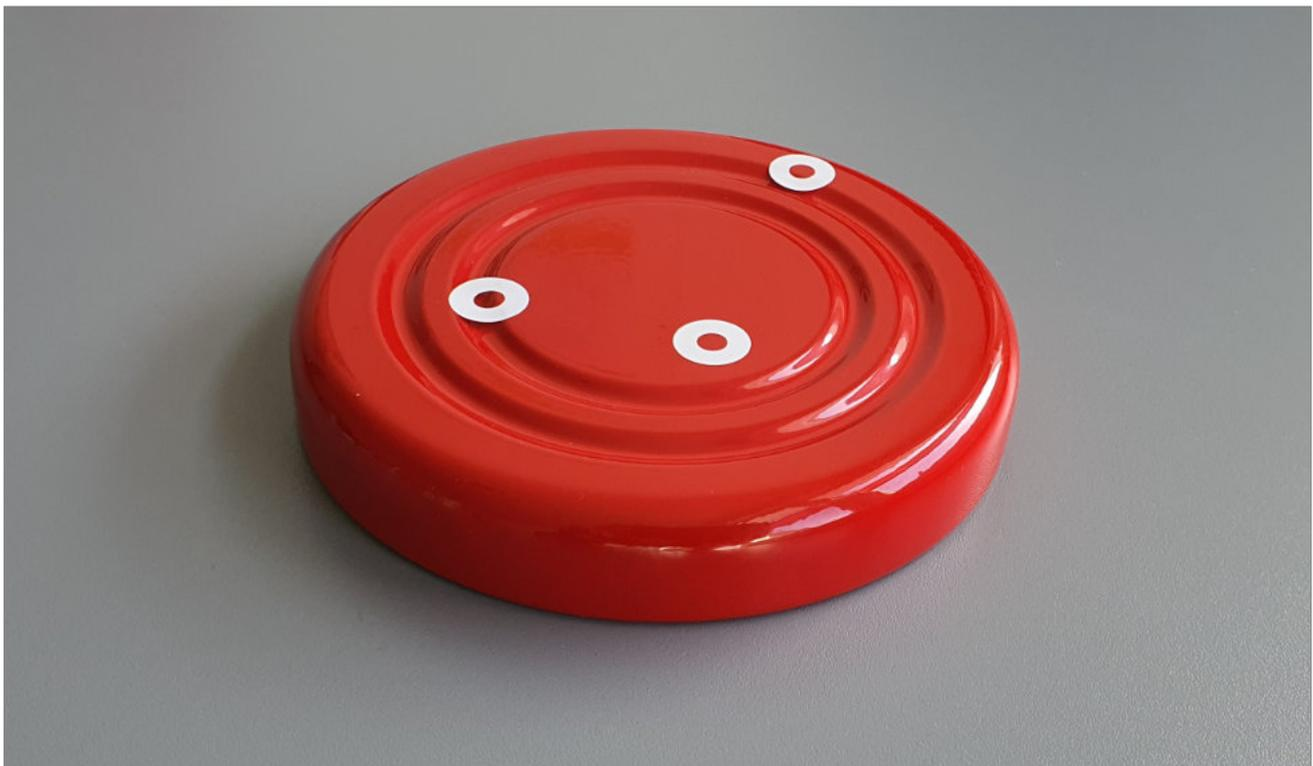
*Bild 19: Ringaufkleber markieren die Stellen, an denen die Referenzschichtdicke bestimmt wurde*
