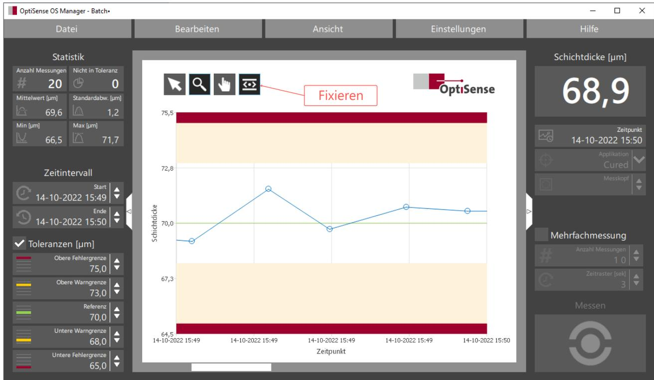
Bild 10: Mit dem Fixieren-Werkzeug wird die Y-Achse eingefroren
