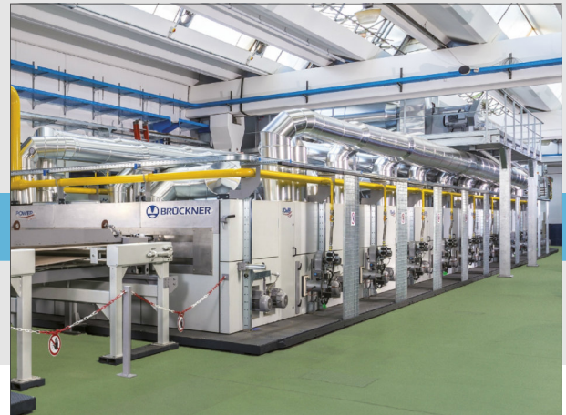
Spannrahmen von Brückner, das „Herzstück“ in der Textilveredlung
