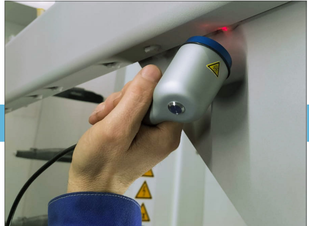
Der PaintChecker mobile von OptiSense misst in jeder noch so kleinen Ecke
