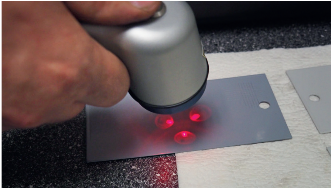
Bei der Messung richtet Carsten Vogelsang den Sensor auf das zu messende Objekt, so dass sich die drei Positions-LEDs in einem Punkt vereinen. Dies erfordert etwas Übung.
