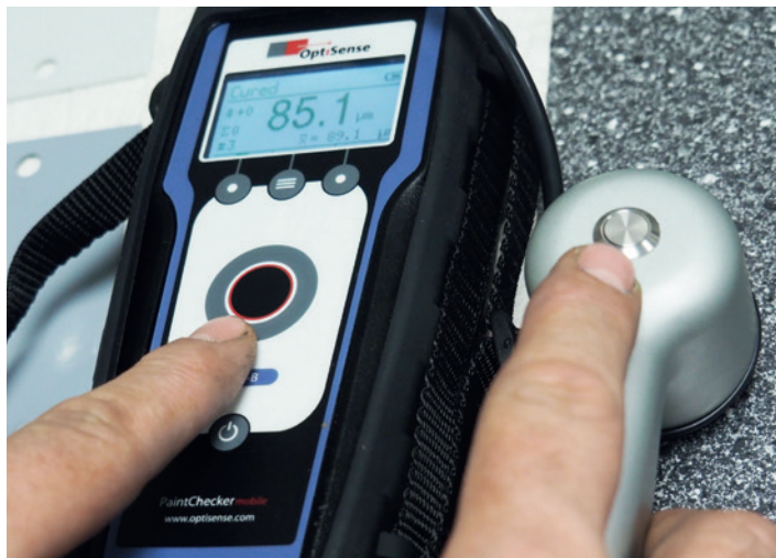
Bei dem weiterentwickelten Gerät kann die Messung nun am Kopf der LED-Pistole oder direkt am Gerät ausgelöst werden kann.
