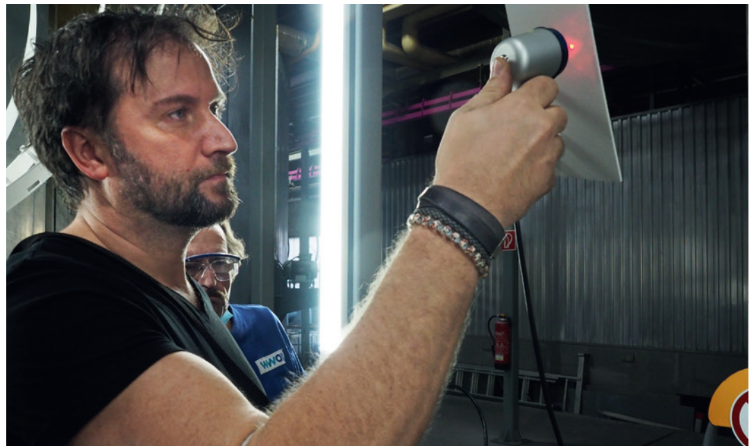
Die Messungen kann Carsten Vogelsang schnell durchführen. Diese erfolgen bei WWO unmittelbar nach der Pulverapplikation vor dem Einbrennprozess.
