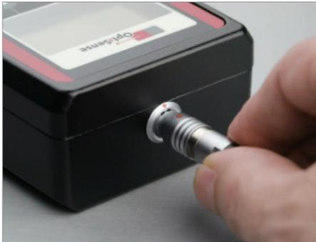
Der PaintChecker Mobile besteht aus einem Handsensor und einem Controller, die über ein Kabel miteinander verbunden werden:
