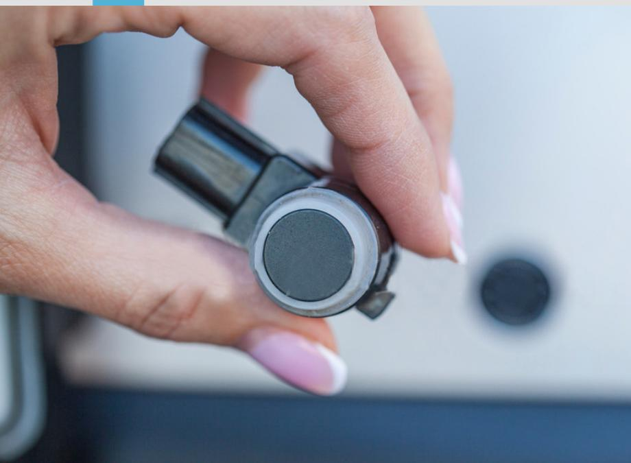
fahren. „Das System hat uns sofort überzeugt: eine zuverlässige und schnelle Schichtdickenmessung als sicher zu steuernde, automatisierte Lösung“, zeigt sich der ILB-Seniorchef zufrieden. Denn für die Pulverbeschichtung samt Prüfmessung bei Abdeckkappen, wie sie bei Einparkhilfesensoren zum Einsatz kommen, gelten besondere Anforderungen.
