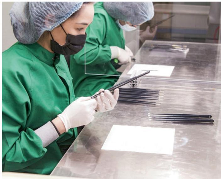
An die Beschichtung dieser OP-Pinzetten werden zahlreiche Anforderungen gestellt: Sie sollen elastisch, gut haftend, hohlräumfrei und schmutzabweisend sein. Diese Anforderungen lassen sich nur mit einer genau bemessenen Schichtdicke erfüllen.
