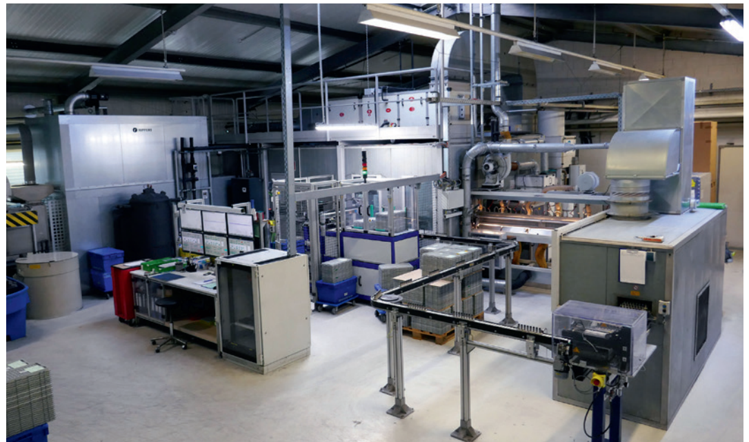
Damit die Qualität selbst bei anspruchsvollsten Pulverbeschichtungsaufträgen der Automobilindustrie stimmt, setzt die ILB bei sämtlichen Anlagen auf Schichtdickenprüfsysteme von OptiSense.
