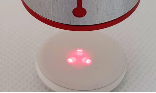
Resim 11: Ölçüm nesnesine yanlış mesafe
