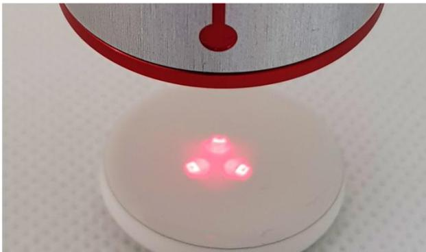
*Figure 11: Distance incorrecte par rapport à l'objet de la mesure*
