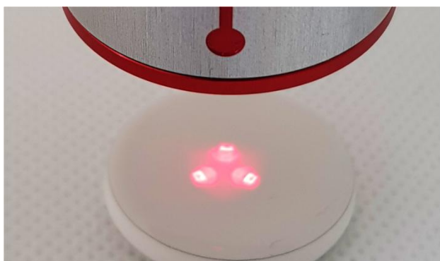
Ilustrace 11: Nesprávná vzdálenost od měřeného objektu
